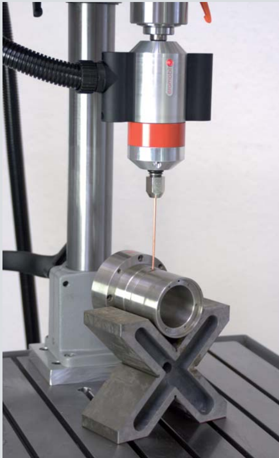
Erosionado con avance automático
