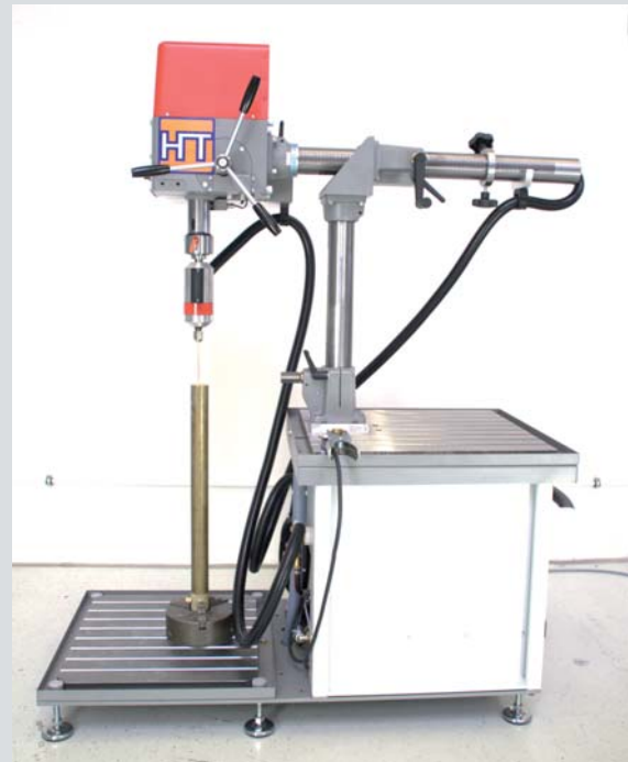
Erosionado de grandes piezas en la mesa posterior de la unidad erosionadora radial fija
