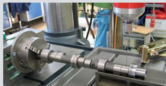
Erosionado de un árbol de levas. En lugar de la broca, en la máquina se sujeta el cabezal oscilante del equipo erosionador
