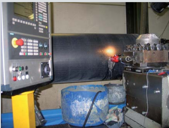
Erosionado horizontal en un torno CNC. La regulación del avance se realiza manualmente por medio del volante
